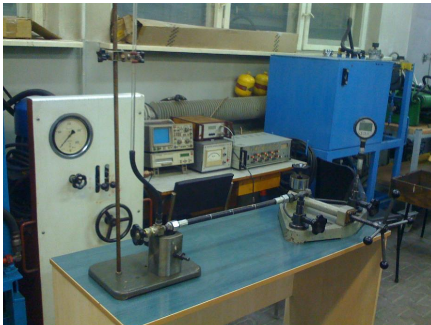
Rys. 2. Widok stanowiska pomiarowego do badania wpływu ciśnienia statycznego na moduł sprężystości cieczy
